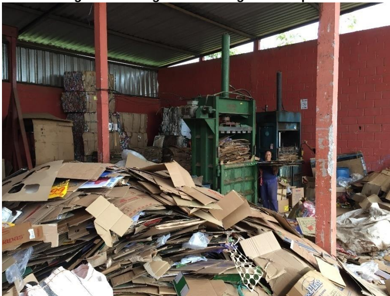
Figura 42: Triagem e Prensagem de Papelão
