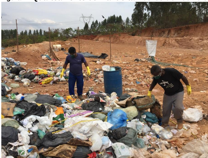
Figura 4: Quarteamento utilizando tambores de 200 litros
